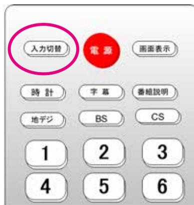
モニター画面にシミュレーション映像が出力されない場合は、リモコンの[入力切替]ボタンで信号入力元をHDMI1に切り替えて下さい。
