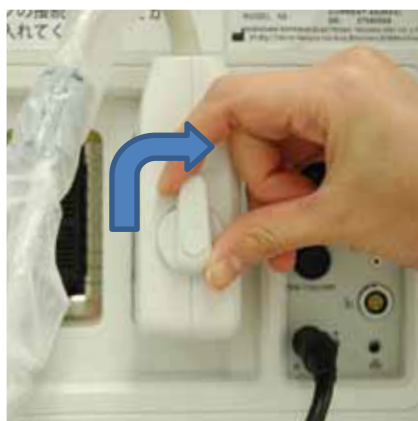
②後ろのバーを回し、プローブが外れないように固定します。
