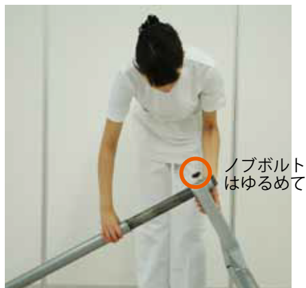
② 支柱を装置用台に通します。ケガのない様に床に置いて作業を行ってください。
