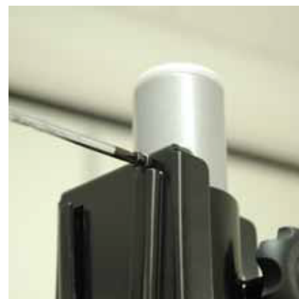
③モニター固定具の受け側の抜け留め防止ネジを外します。
