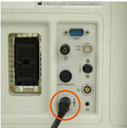
④超音波装置背面の「DC in 15V」にケーブルを接続します。
