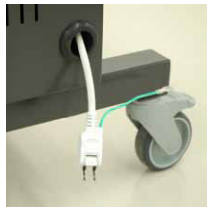
後ろ面の配線孔から電源用 OA タップのコードを出します。
