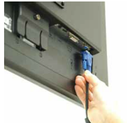
モニター裏側の「D-SUB」に映像ケーブルを接続します。
