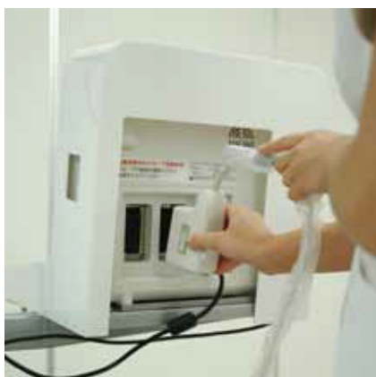
①教育用超音波装置背面にプローブを接続します。左右どちらにつないでも構いません。
