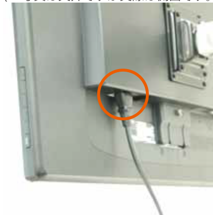
⑤モニター裏側の「D-SUB」にケーブルを接続します。
