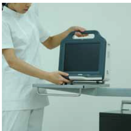
① 教育用超音波装置を装置用台のガイドに沿って設置します。
