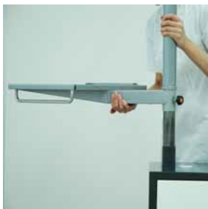
④ 支柱をユータスペースに組み付けます。装置台と支柱をしっかりと持ち、ゆっくりとベースのパイプに差し込んでください。
