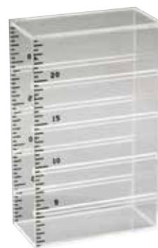
各測定部が5、10、15、20mmの高さに設置できる構造になっています。
