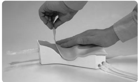
2. 皮膚とパッドは接着されていませんので、皮膚だけをつかみますとパッドからはがれてしまいます。もし、はがれてしまった場合は、空気を抜きながら元どおり貼り付けてください。パッドと皮膚の間に空気の層ができると、超音波の画像に影響が出ます。
