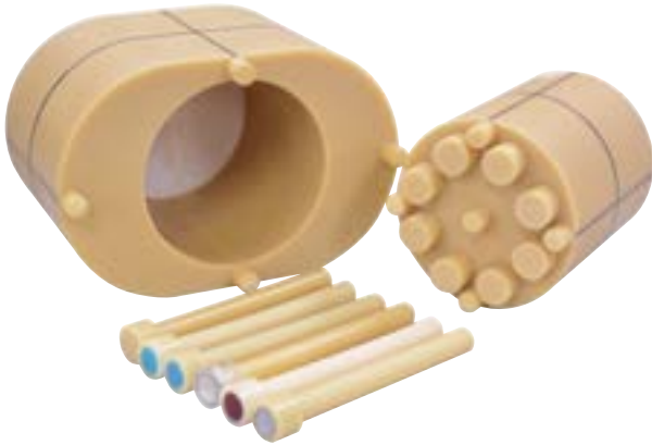
TR-J型: JIS Z4915規格準拠胸部用X線水ファントムと断面形状が同じ
