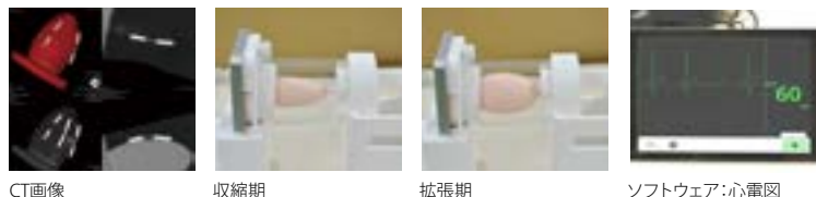
心電図同期型心臓動態ファントムです。 ※写真はプロトタイプです。
