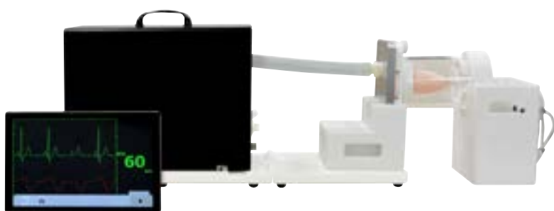
心電図同期型心臓動態ファントムです。 ※写真はプロトタイプです。
