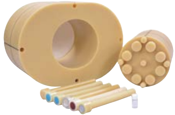
TR-I型: JIS Z4923:2015準拠ファントム (φ320mm) と断面積が同等
